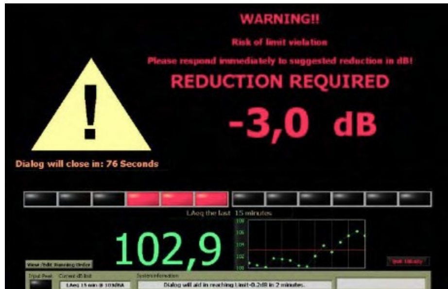
Figura 6: Ejemplo de sistema de precaución indicando una reducción requerida de 3 dB. Esto se visualiza a través de una pantalla en FOH.
