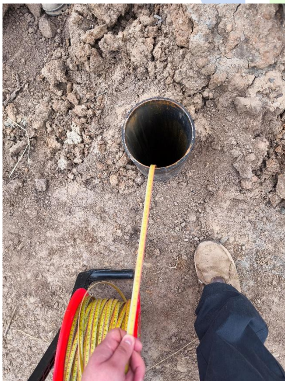
3. Medición de Profundidad de Nivel estático de Agua (17,8 metros)
