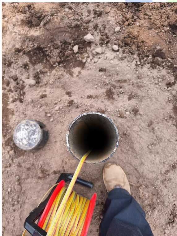
2. Medición de Profundidad de Nivel estático de Agua (21,65 metros)
