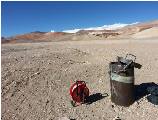
Figura 16: Medición de nivel de agua en el pozo LNFTW-01
