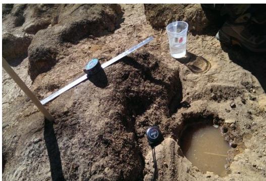
Figura 13: Preparación de Ensayo de Infiltración
