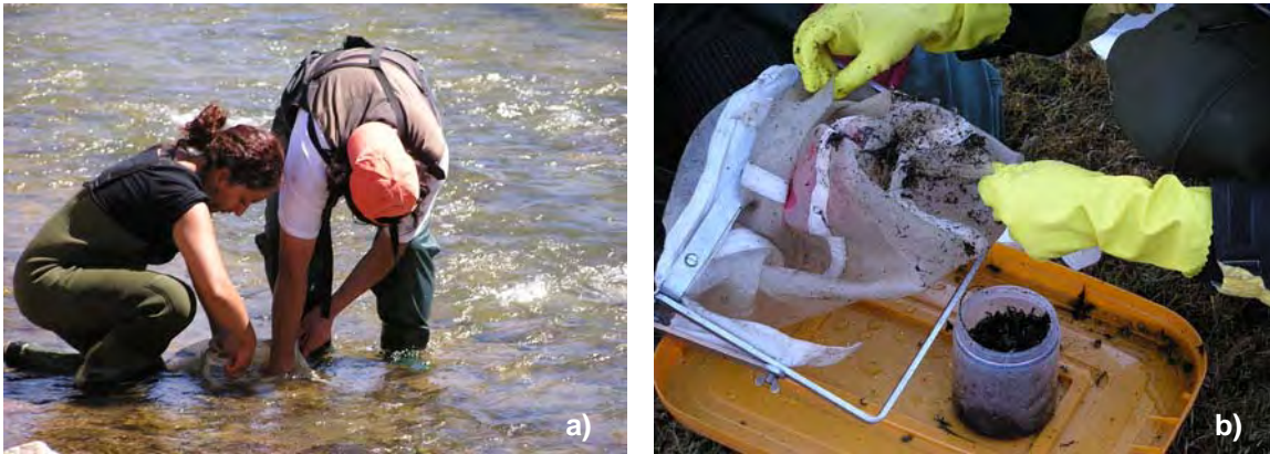
Figura 3.3. Metodología utilizada en el muestreo de macroinvertebrados. a) Toma de la muestra, b) Muestreador (Red Surber).
