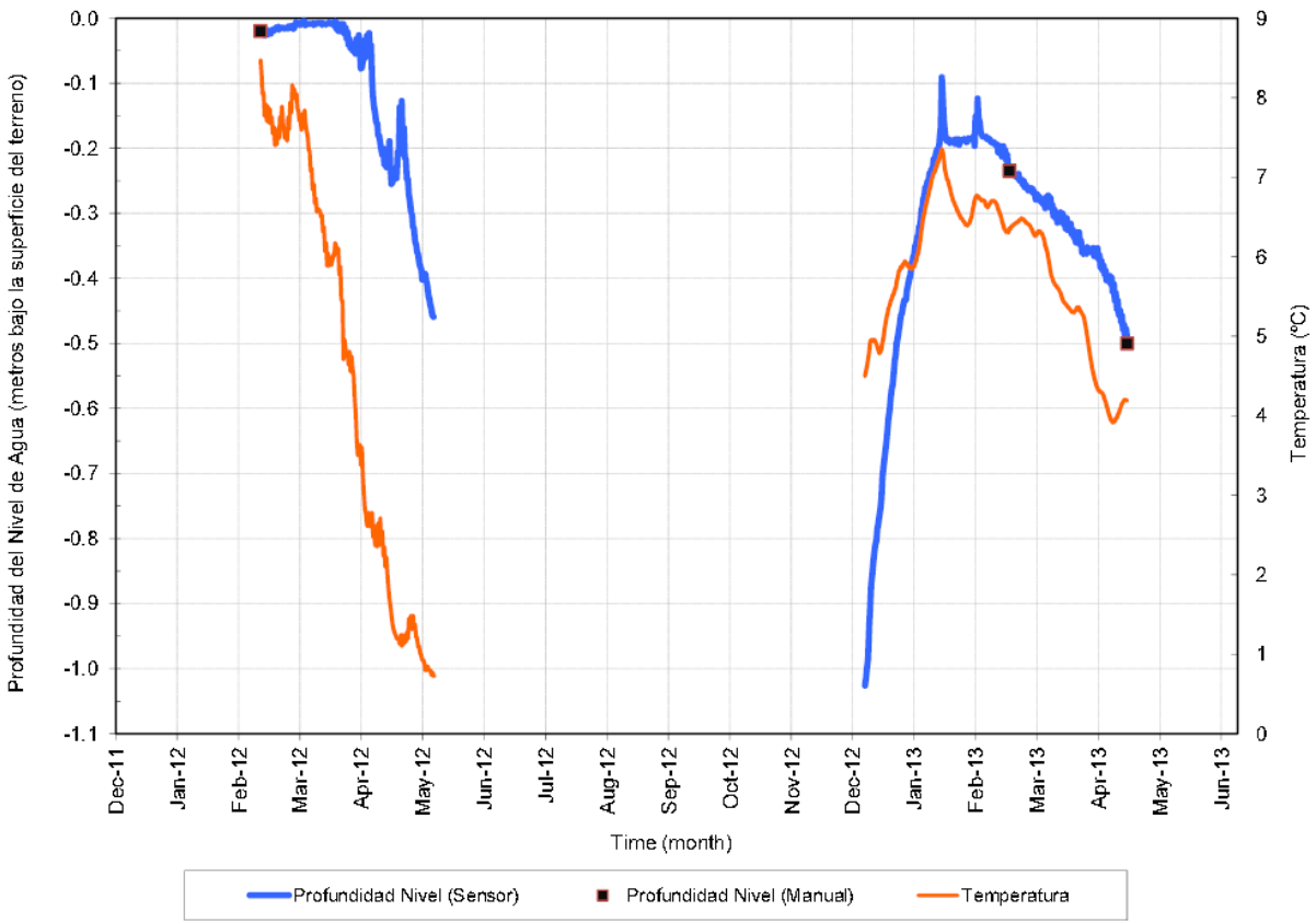
Figura 2. Datos de nivel de agua y temperatura colectados en data logger en la vega NE-5
