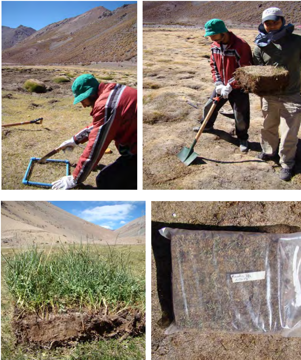
Figura 3. Proceso de obtención de muestra desde el corte del cuadrante hasta el embolsado y etiquetado de las muestras. a) Cortado del cuadrante (arriba, izquierda), b) Obtención de la muestra (arriba, derecha), c) Muestra obtenida (abajo izquierda), d) Embolsado y etiquetado (abajo, derecha).
