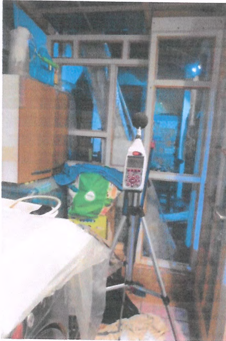
FOTO N° 13: MEDICIÓN EN SECTOR DE LAVADORA EN CASA VECINA (RECEPTORES).
