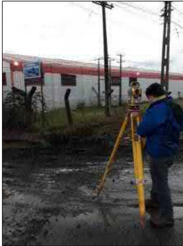
Fotografía 2: Realización de levantamiento mediante estación total
