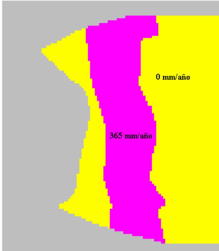
Figura 4.28: Área definida en el modelo con potencial de evaporación. La profundidad de extinción considerada es de 1 m.
