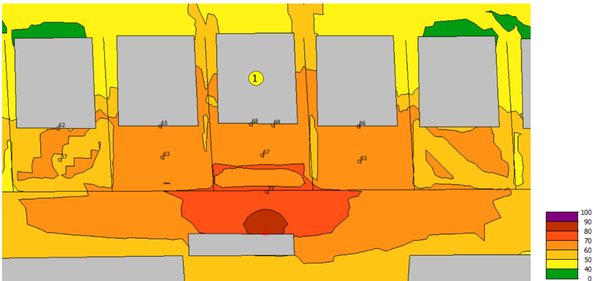
Figura 10. Mapa de ruido de escenario de emisión de ruido con grúa operando cercana al punto receptor 1 sin pantalla acústica.
