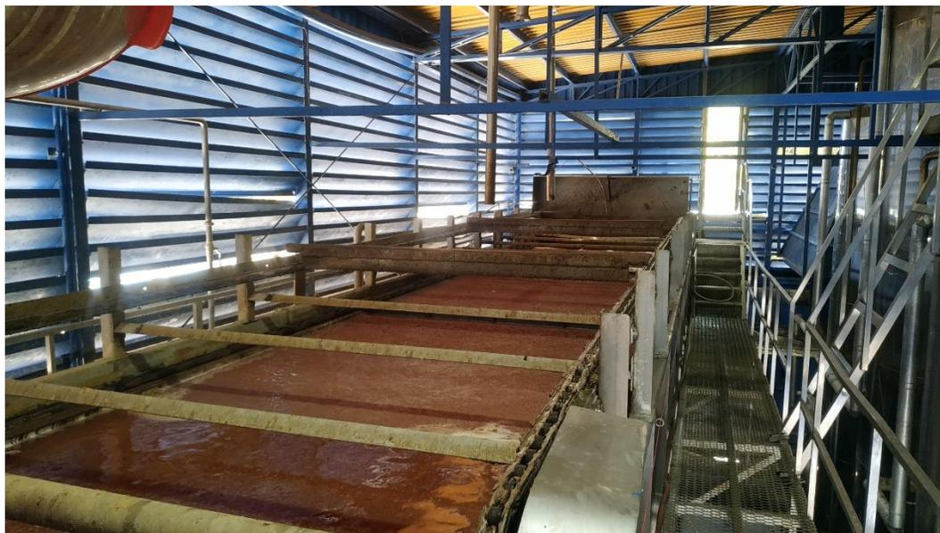
Imagen N°5: Celda de Flotación 2
