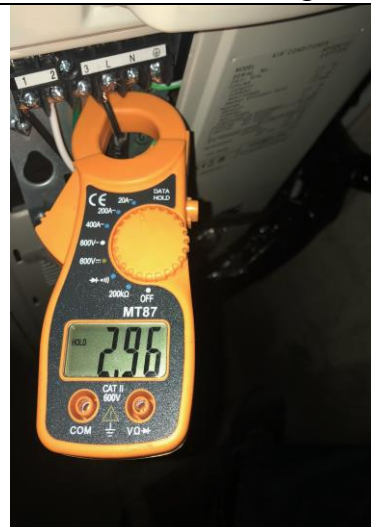
Puesta en marcha equipo y consumo compresor
