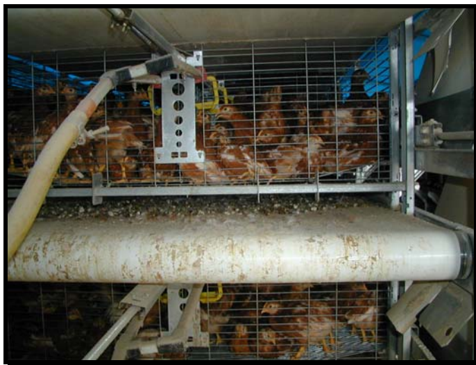
Fotografía 2: Vista plantel de ponedoras en región de Coquimbo. Retiro de guano automatizado y diario
