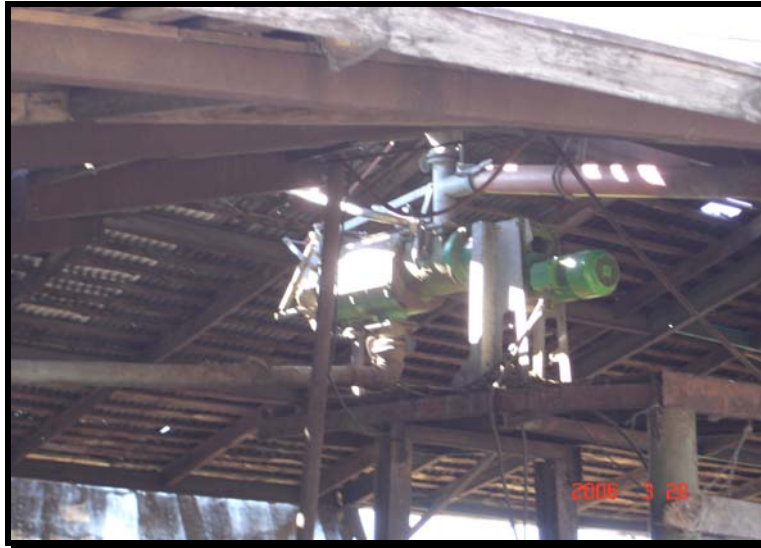
Fotografía 10.- Prensa separadora de sólidos-líquidos. Lechería. Sector Angol, IX Región.
