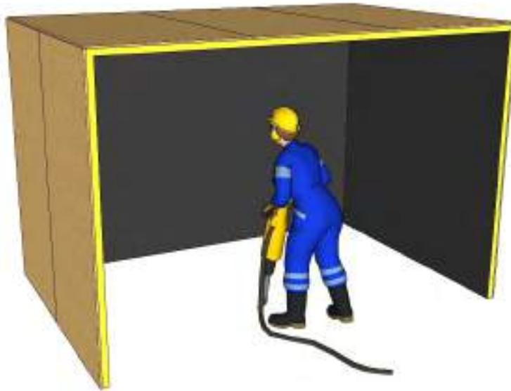
Figura 3. Semi-encierro para trabajos puntuales en exterior.
