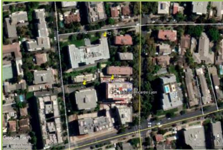
En la *Figura 1*, se muestra con un punto rojo la fuente, y con puntos amarillos, los receptores, donde, en el emplazamiento de cada receptor, se deberán respetar los niveles máximos permisibles según el uso de suelo correspondiente asignado.
