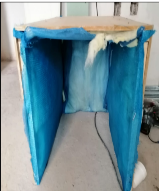
Pantalla de aislamiento acústica empleada en bomba de hormigón
