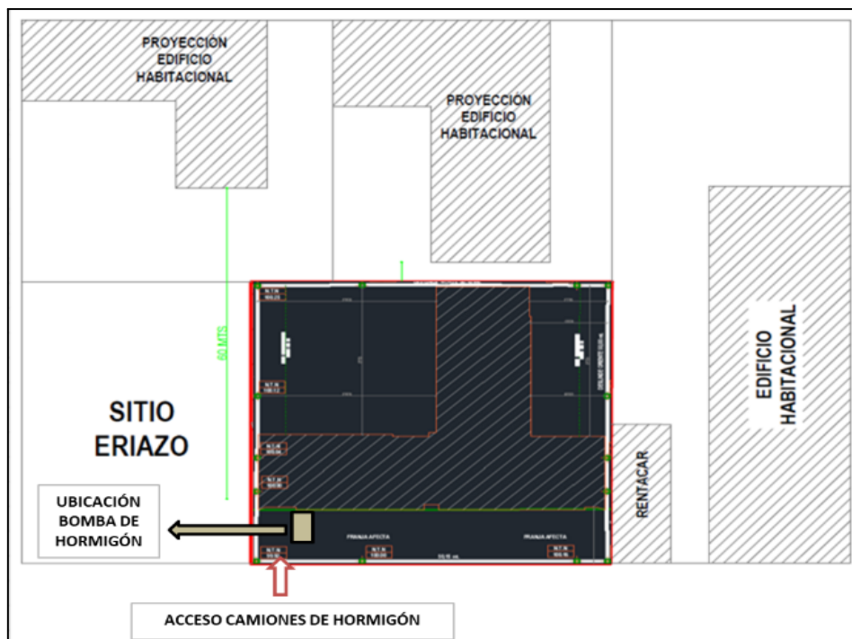
Ubicación bomba de hormigón
