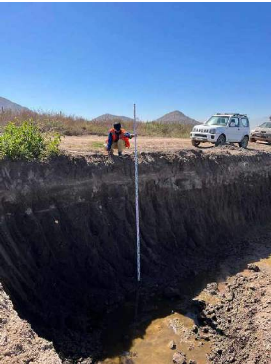
Fotografía 4. Perfil de suelos en el límite del área intervenida. Los horizontes Ap, B 1 , B 2 y B 3 tienen una potencia de entre 80 cm a 1 m, mientras que el horizonte II C 1 tiene una potencia de 2 m aproximadamente.
