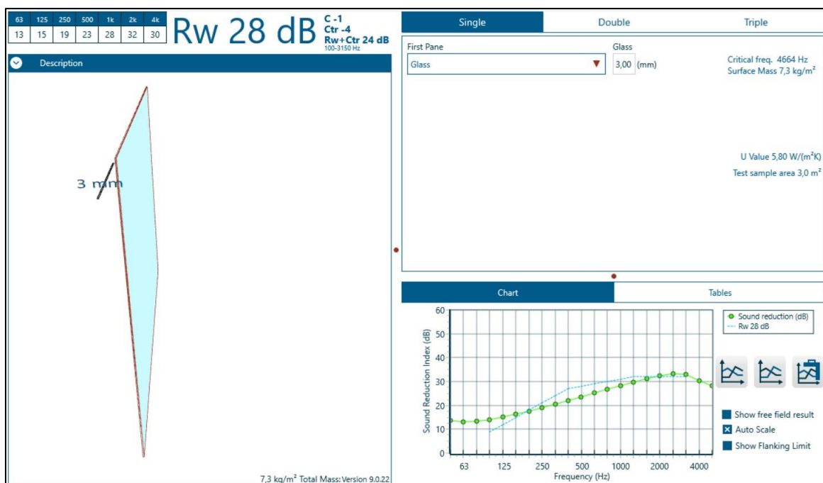
Figura 5: Detalle de atenuación sonora para vidrio monolítico de 3 mm. Fuente: Base de datos de Software Marshall Day Acoustics INSUL R_w=28 dB.
