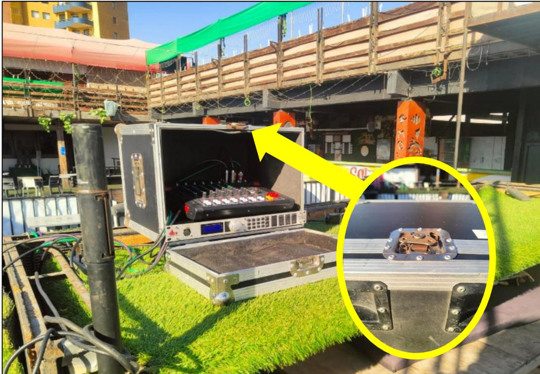
**Figura 11:** Incorporación de limitador en la salida de la mesa de audio para controlar centralizadamente la salida de audio. El limitador se encuentra en un rack con posibilidad de trabajo cerrado con candado.
