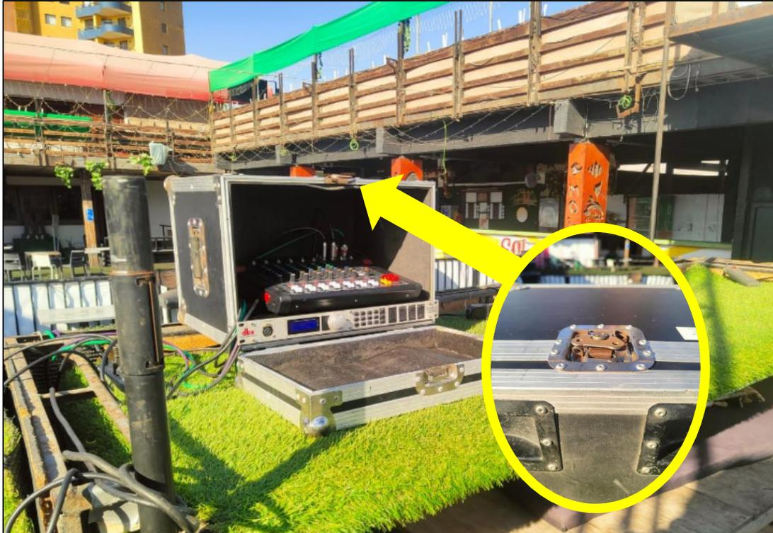
**Figura 10:** Incorporación de limitador en la salida de la mesa de audio para controlar centralizadamente la salida de audio. El limitador se encuentra en un rack con posibilidad de trabajo cerrado con candado.
