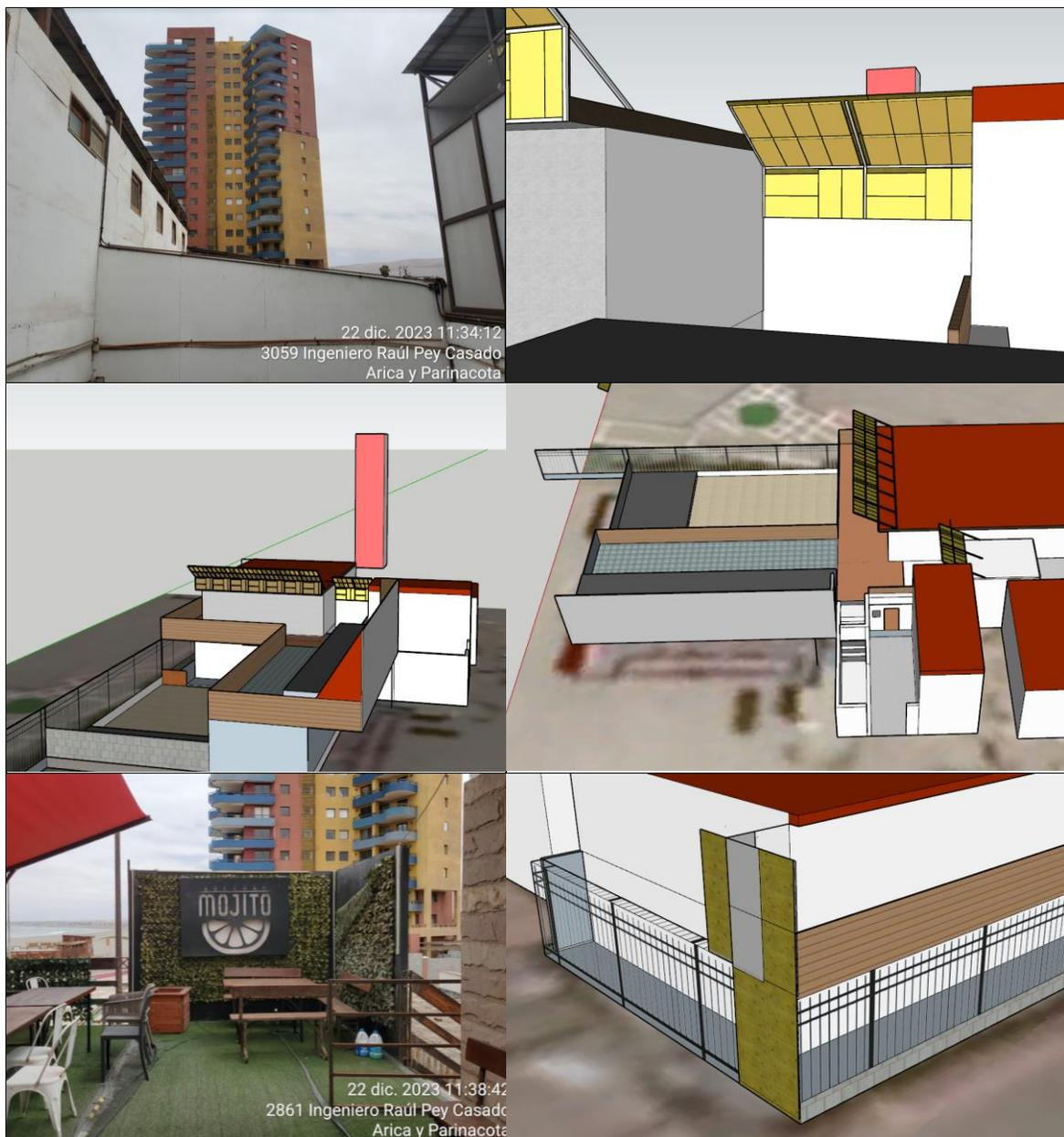
**Figura 14:** Esquema de montaje de barrera de contención en perímetro superior de pista de baile y perímetro trasero del recinto con planchas de OSB de 18 mm.
