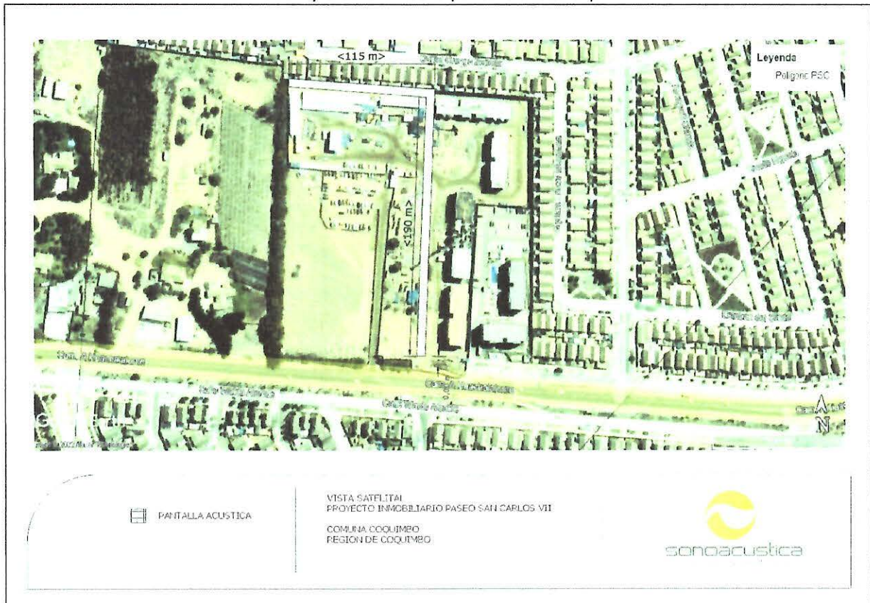
Ilustración 11. Ubicación y extensión de la pantalla acústica perimetral
