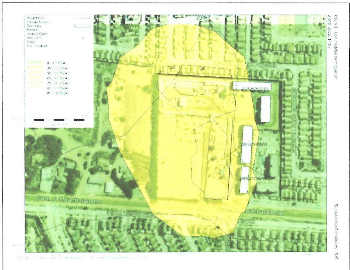
Ilustración 15. Mapa de ruido Fase de Construcción (con medidas de control implementadas).
