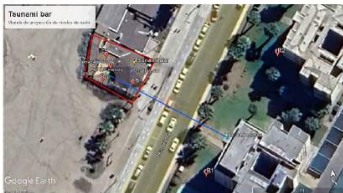
Ilustración 8. Disposición de fuentes y receptores. Proyección de ruido según ISO 9613.
