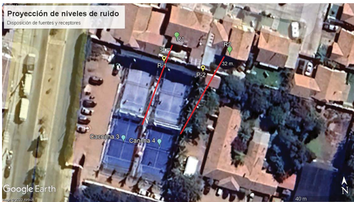
Ilustración 7. Disposición de fuentes y receptores. Proyección de ruido según ISO 9613.
