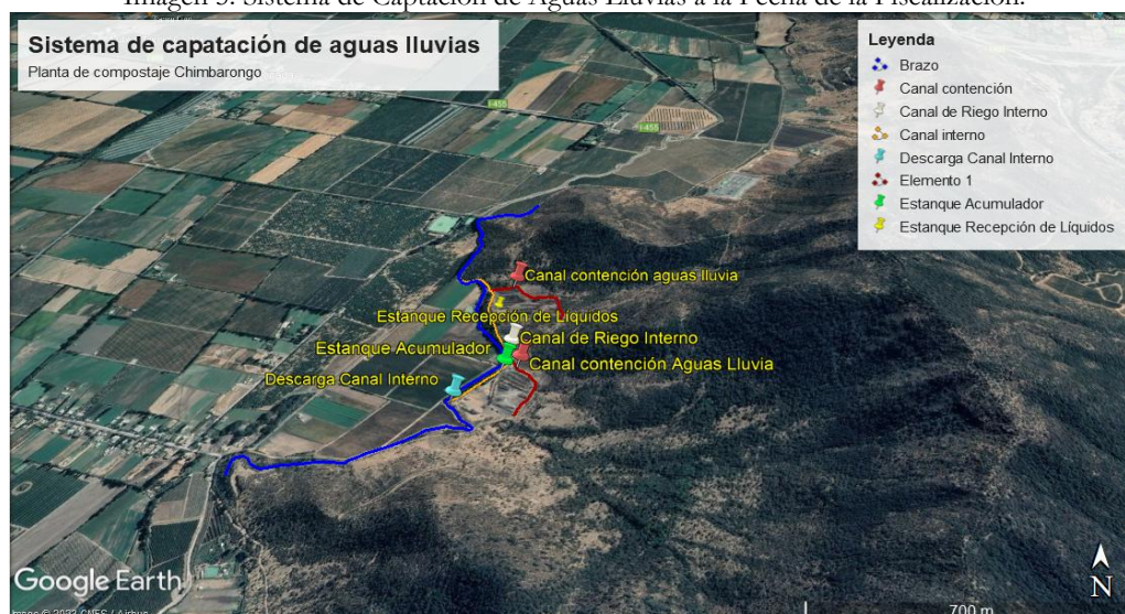
Imagen 5. Sistema de Captación de Aguas Lluvias a la Fecha de la Fiscalización.
