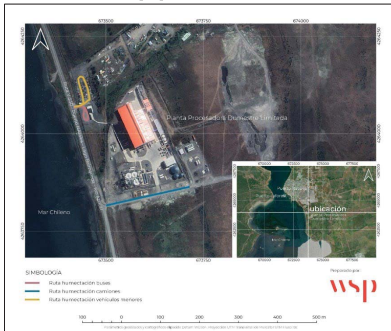
Figura5: Rutas de humectación propuestas en el marco del PDC de Planta Dumestre.
