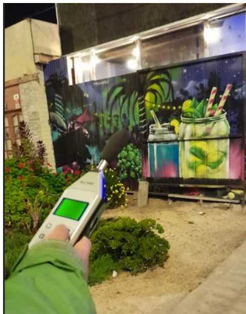
Figura 4. Sonómetro utilizado durante medición
