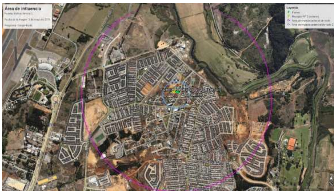
ILUSTRACIÓN 2 DETERMINACIÓN DEL ÁREA DE INFLUENCIA CON UN RADIO DE 138 METROS. ELABORACIÓN PROPIA EN BASE A SOFTWARE GOOGLE EARTH PRO. EN COLOR AZUL SE PUEDE OBSERVAR EL PERÍMETRO DEL ÁREA DE INFLUENCIA DETERMINADA PARA LA FUENTE “EDIFICIO ALMIRAL 2”
