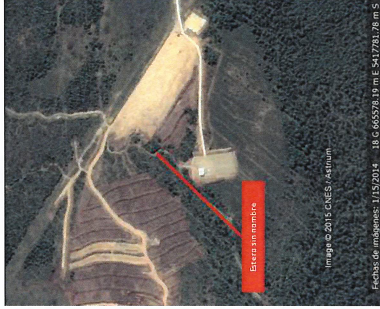
Imagen N° 4: Trabajos de movimiento de tierra dentro del rodal 1 y el estero sin nombre con parte de su área de protección, enero de 2014.
