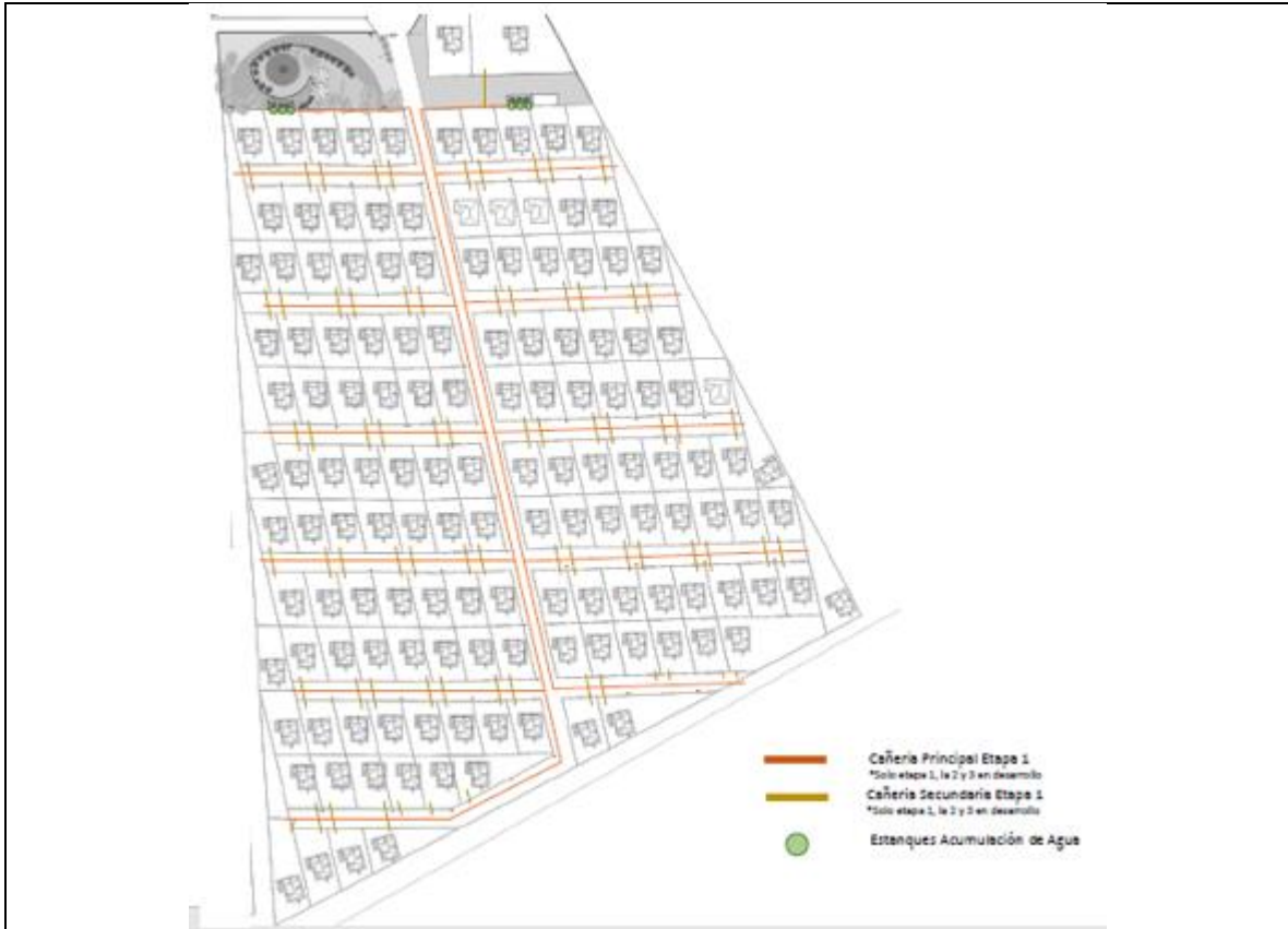
Figura N° 3. Plano proyecto agua de pozo
