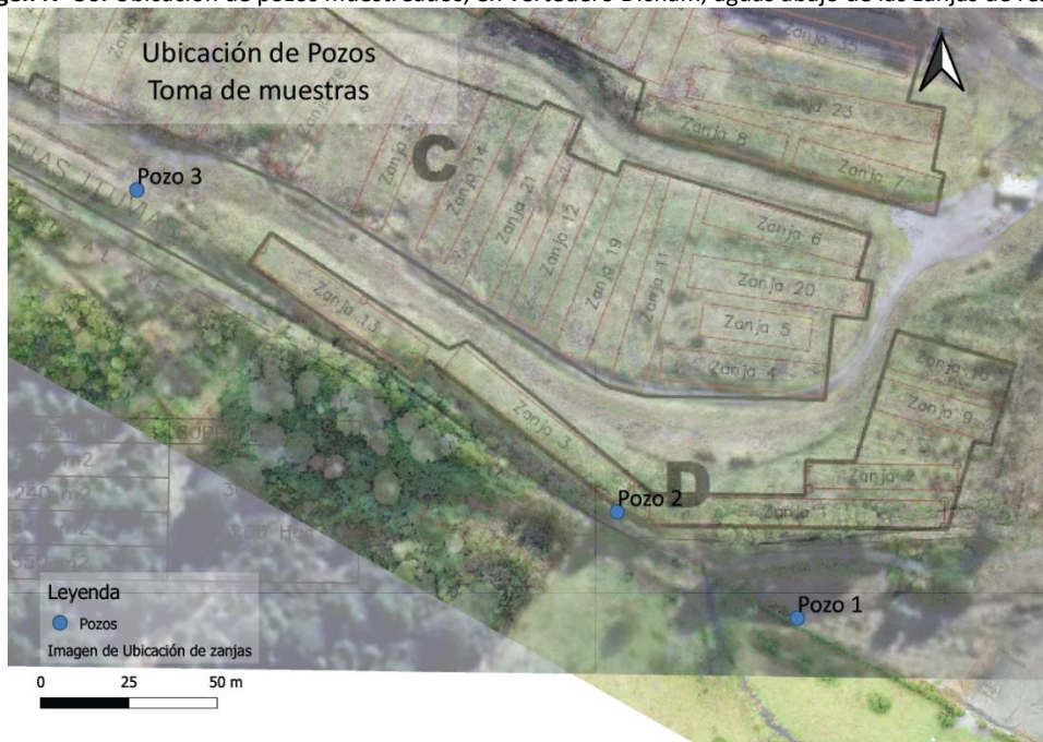
Imagen N° 56: Ubicación de pozos muestreados, en vertedero Dicham, aguas abajo de las zanjas de residuos
