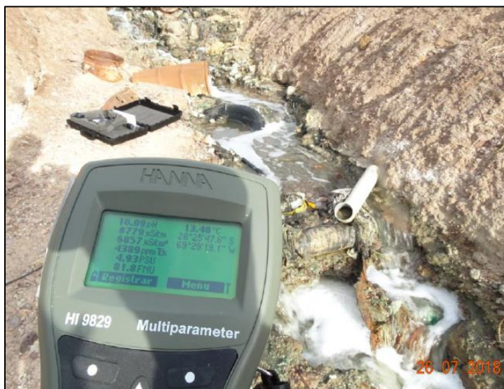
Imagen N° 7 – Medición en terreno con sonda multiparamétrica
