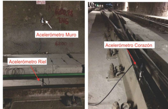
Imagen N° 2: Medición efectividad medida de mitigación -20 dB
