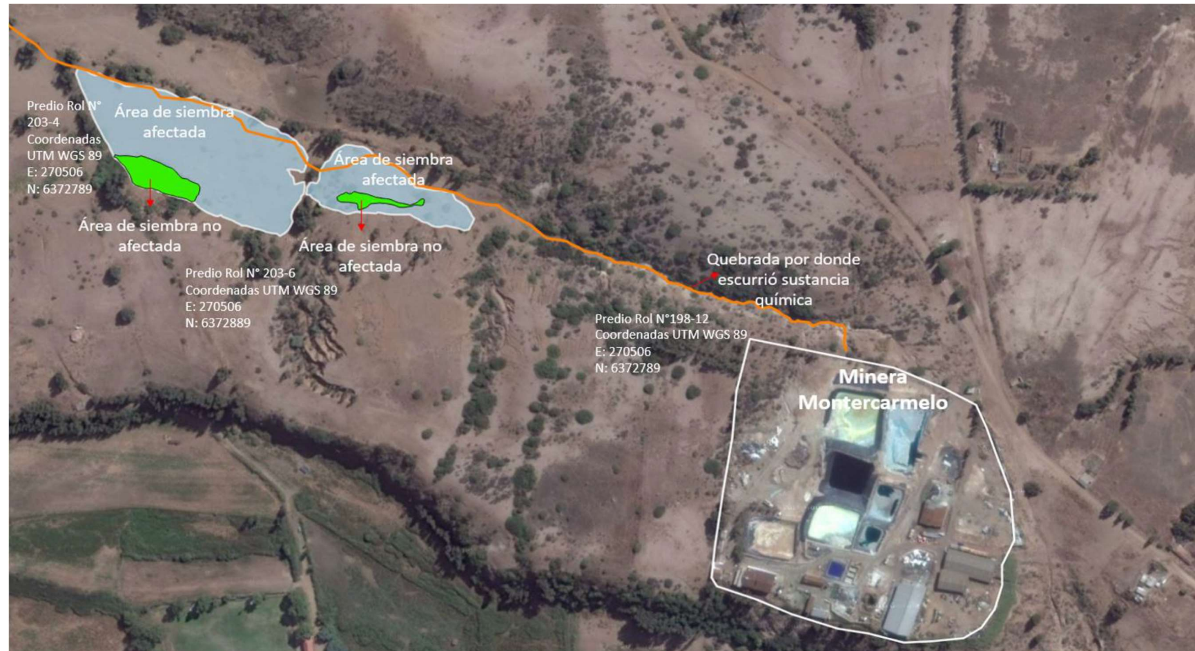
Imagen 12. Instalaciones de Minera Montecarmelo, identificación de predios afectados, quebrada por donde escurrió la sustancia química y áreas de siembras afectadas y no afectadas.
