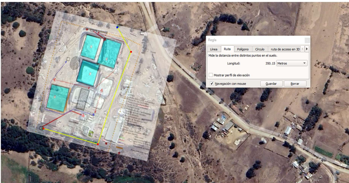
Imagen 20. Determinación de extensión del sistema de canalización de aguas lluvias.
