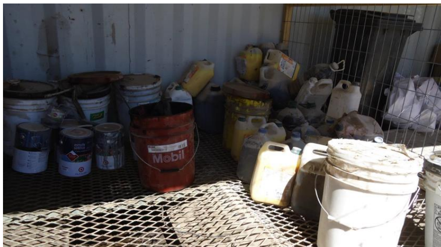
Imagen 4. Residuos peligrosos almacenados sin rotular
