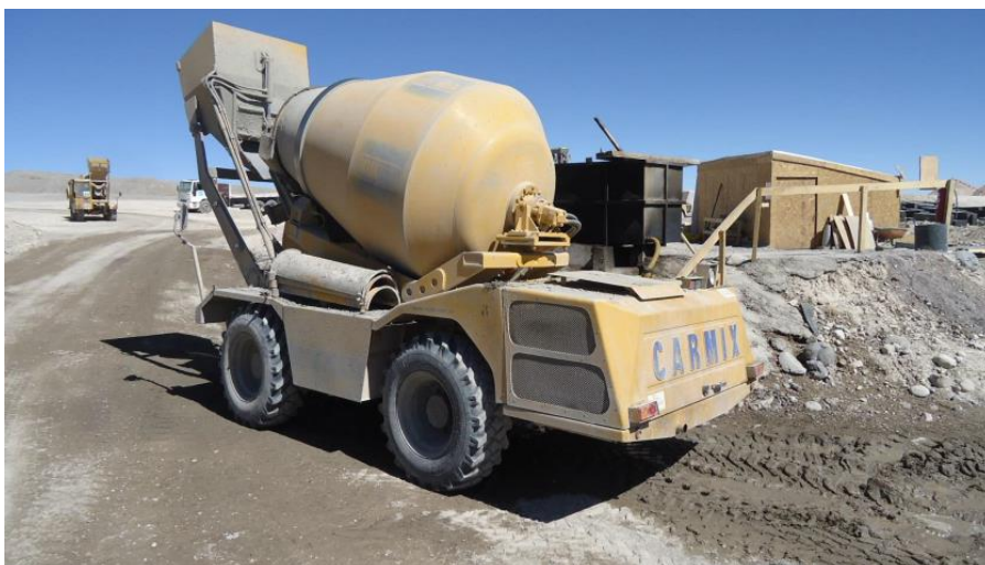
Imagen 11. Camión Mixer para la preparación de hormigón.
