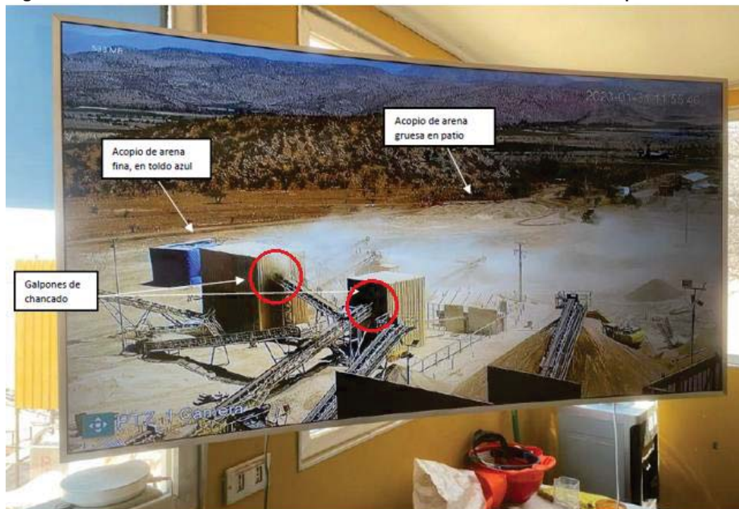
Figura 2. Proceso de chancado sin medidas de control de emisiones de material particulado fino
