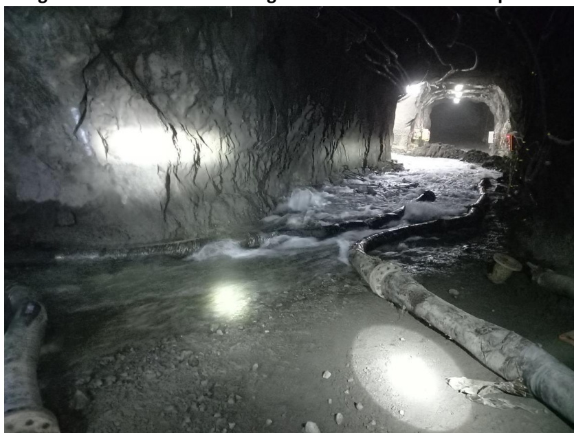
Figura 50. Escurrecimiento de agua al interior de Mina Alcaparrosa
