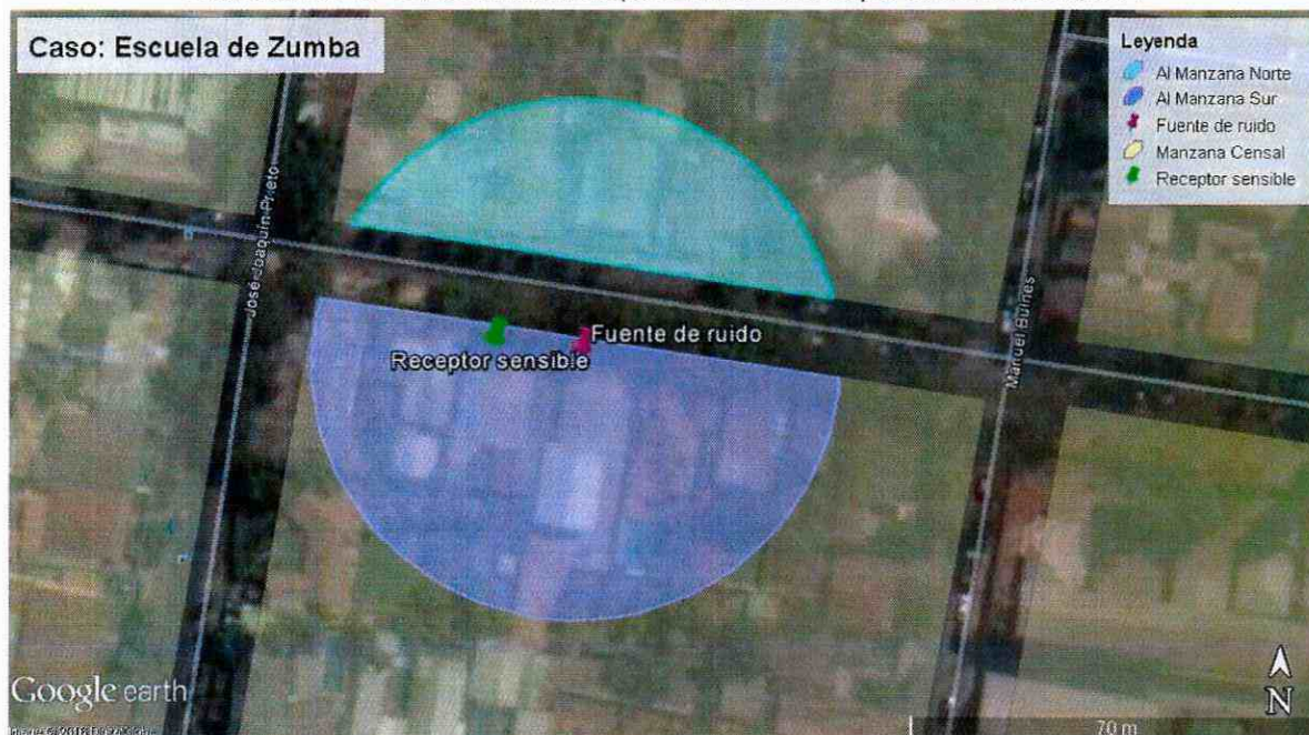
Ilustración N° 2. “Determinación de personas afectadas por la fuente de ruido”.
