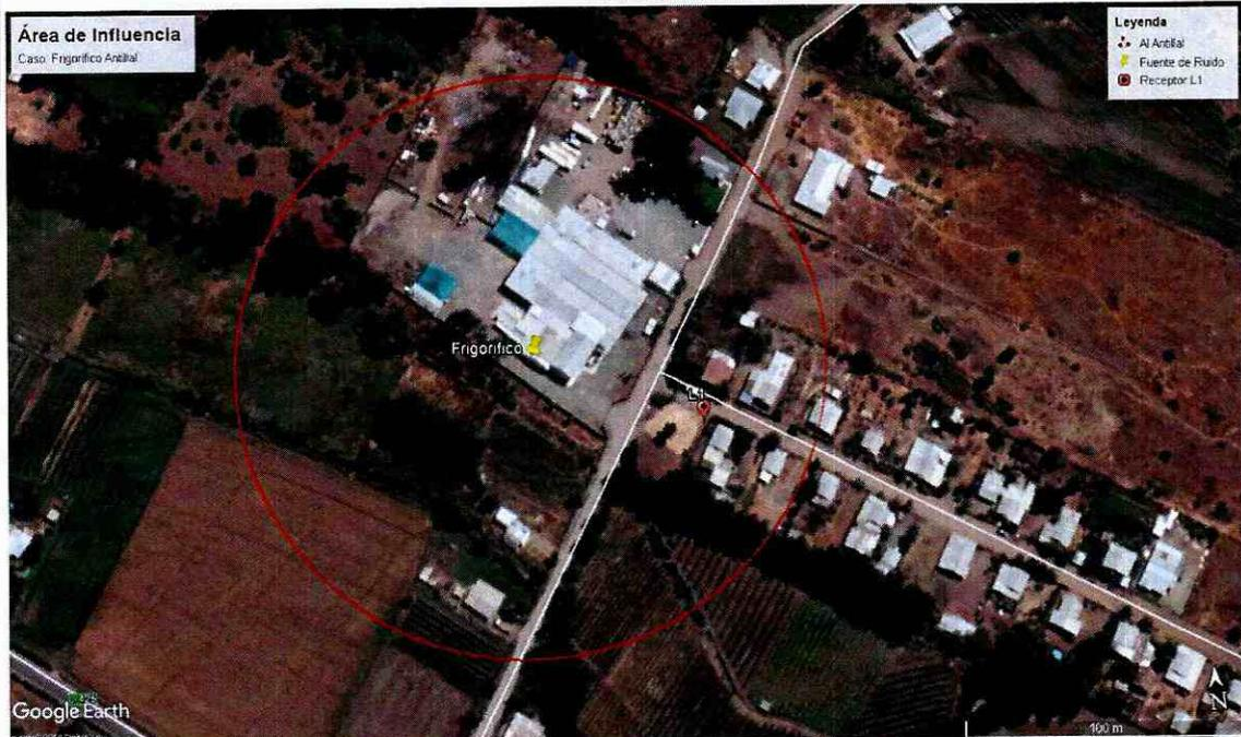
Ilustración 1 Determinación del Área de Influencia con un radio de 113 metros. Elaboración propia en base a software Google Earth. En color rojo se puede observar el perímetro del área de influencia determinada para la fuente "Frigorífico Antilla"
