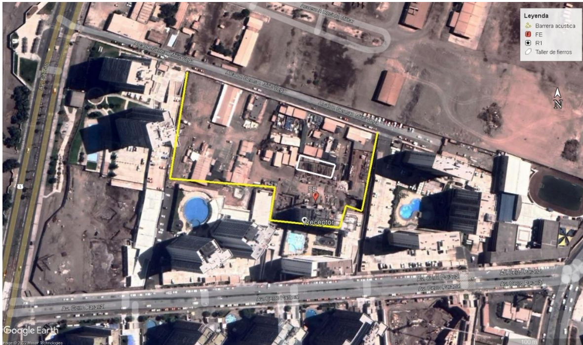
Imagen N°2 Extensión de barrera acústica en perímetro de posibles receptores sensibles.
