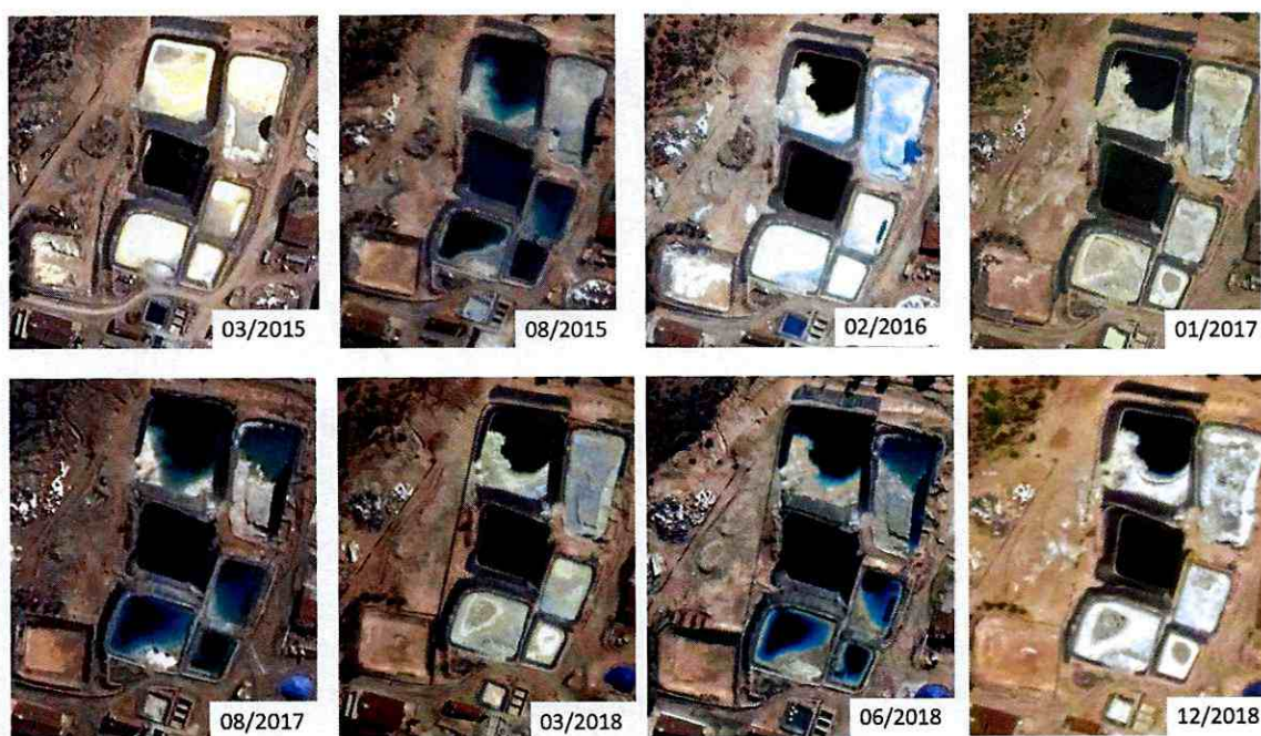
Imagen 21. Almacenamiento de ripio intermedio en piscinas existentes en la Planta de Minera Montecarmelo.
