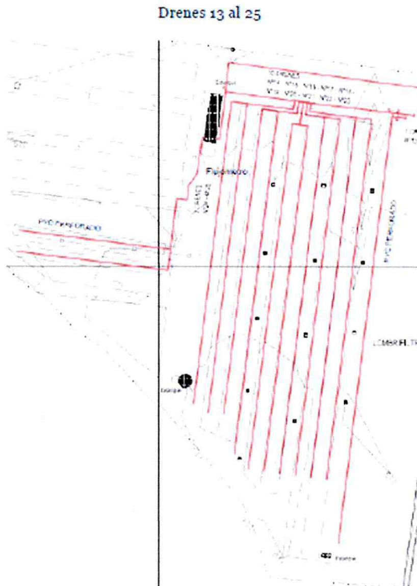
Figura 23. Plano detallado de los drenes del proyecto, drenes 13 al 25
