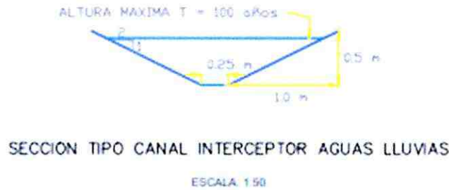
Figura 3. Esquema sección tipo canal interceptor aguas lluvias
