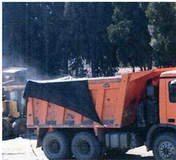
Figura 10. Encarpado deficientemente ejecutado
