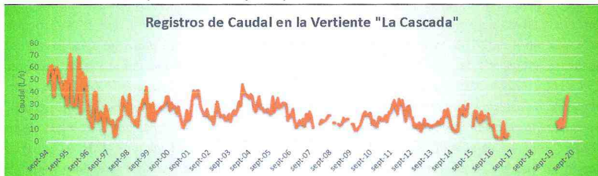
Figura 6. Serie histórica de registros de caudales en la vertiente “La Cascada”, obtenidos de las mediciones de Minera Centinela en el marco del monitoreo ambiental y el Plan de Alerta Temprana en el campo de pozos Calama desde 1994 a 2021
