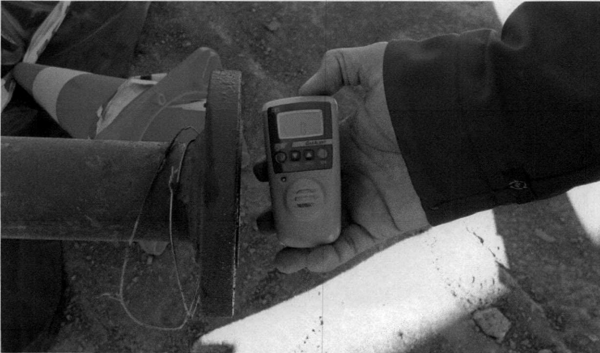
Imagen N° 5.-Medición de gases previo a la extracción de tanque
