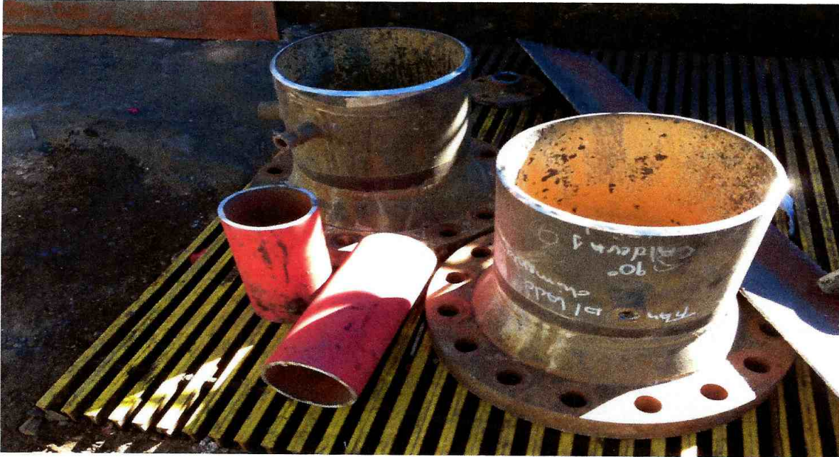
Imagen N°14 : modificaciones carretes y flanges líneas de alimentacion
