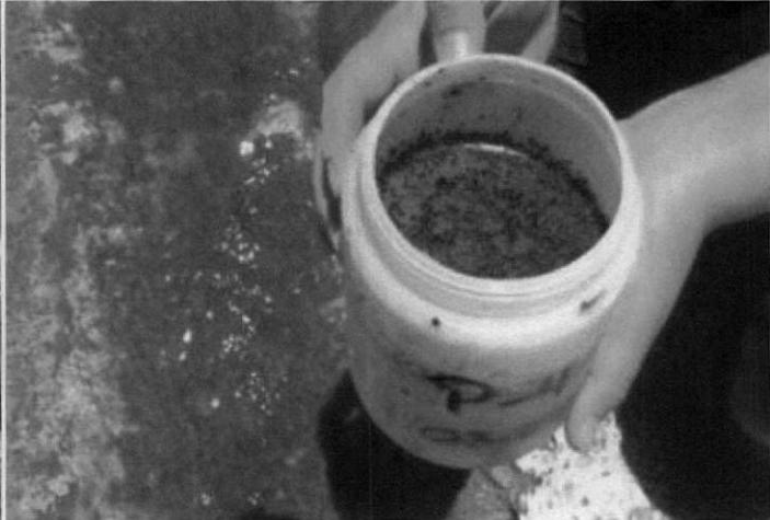
**Foto N°4:** Muestras en la Quebrada Blanca en el momento que se aprecia visualmente la contaminación con combustible Fuel Oil N° 6, tomadas por Cesmec.
