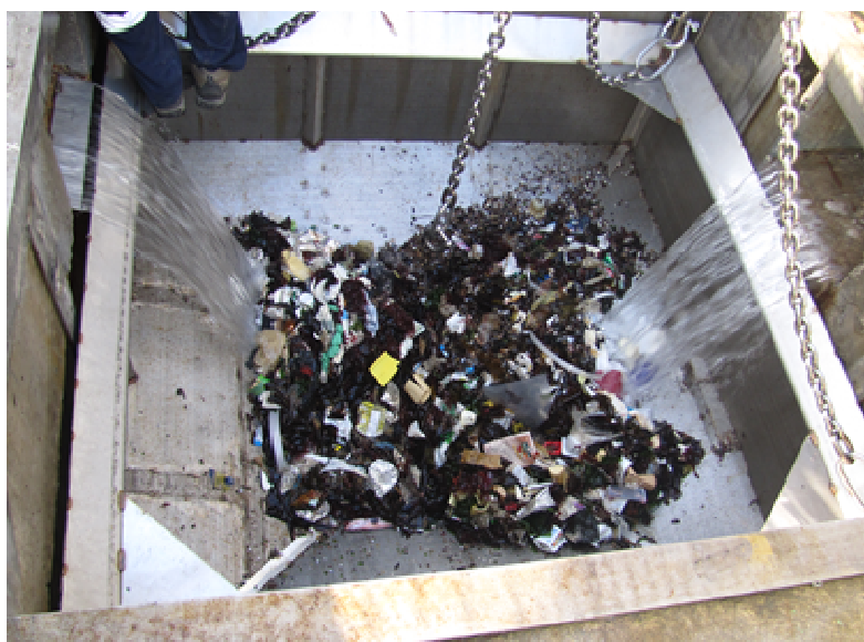
Figura 3. Canastillo de acumulación filtrando el agua marina.
