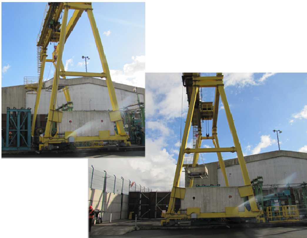
Figura 2. Grúa desplazando el canastillo de acumulación de materiales hacia el lugar de muestreo.
