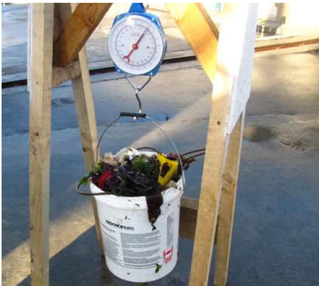
Figura 6. Proceso de pesaje de la muestra (peso total) realizado en el lugar de muestreo.
