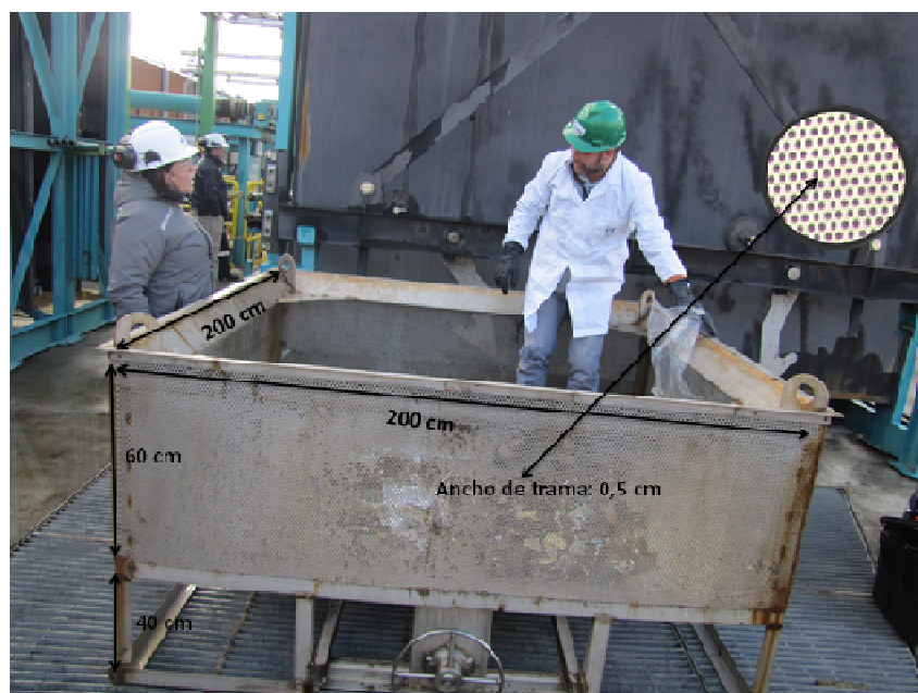
Figura 1. Canastillo de acumulación de materiales y sus dimensiones.
