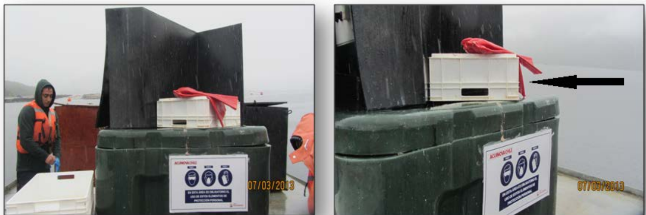
Plataforma de ensilaje de mortalidad, en el cuál se encuentra el sistema triturador y IBC de mortalidad o acopio (1mt3 de capacidad). Se observa indicado con una flecha que no cuenta con la tapa original que realiza un selle hermético, si no que en su lugar se encuentra una gamela o bandeja blanca a modo de una improvisada tapa.
