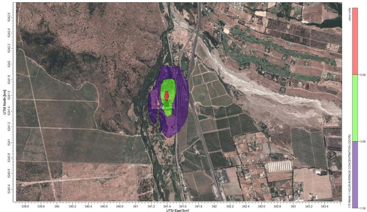
**Figura 9.** Modelización de la PTAS de ESSBIO de San Francisco de Mostazal. Isodoras 1,5, 3 y 5  $uo_E/m^3$  percentil 98. Representación sobre ortofotografía.
