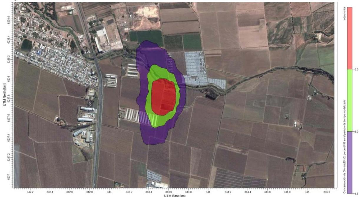
**Figura 11.** Modelización de parcela de compost de Agrícola Garcés. Isodoras 1,5, 3 y 5  $uo_E/m^3$  percentil 98. Representación sobre ortofotografía.
