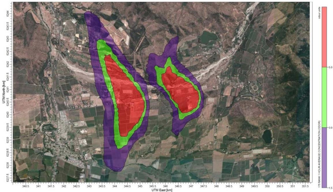
**Figura 8.** Modelización de los focos de emisión de olor considerados de la planta de nutrición animal de Proex de San Francisco de Mostazal. Isodoras 1.5, 3 y 5 uo<sub>E</sub>/m<sup>3</sup> percentil 98. Representación sobre ortofotografía.
