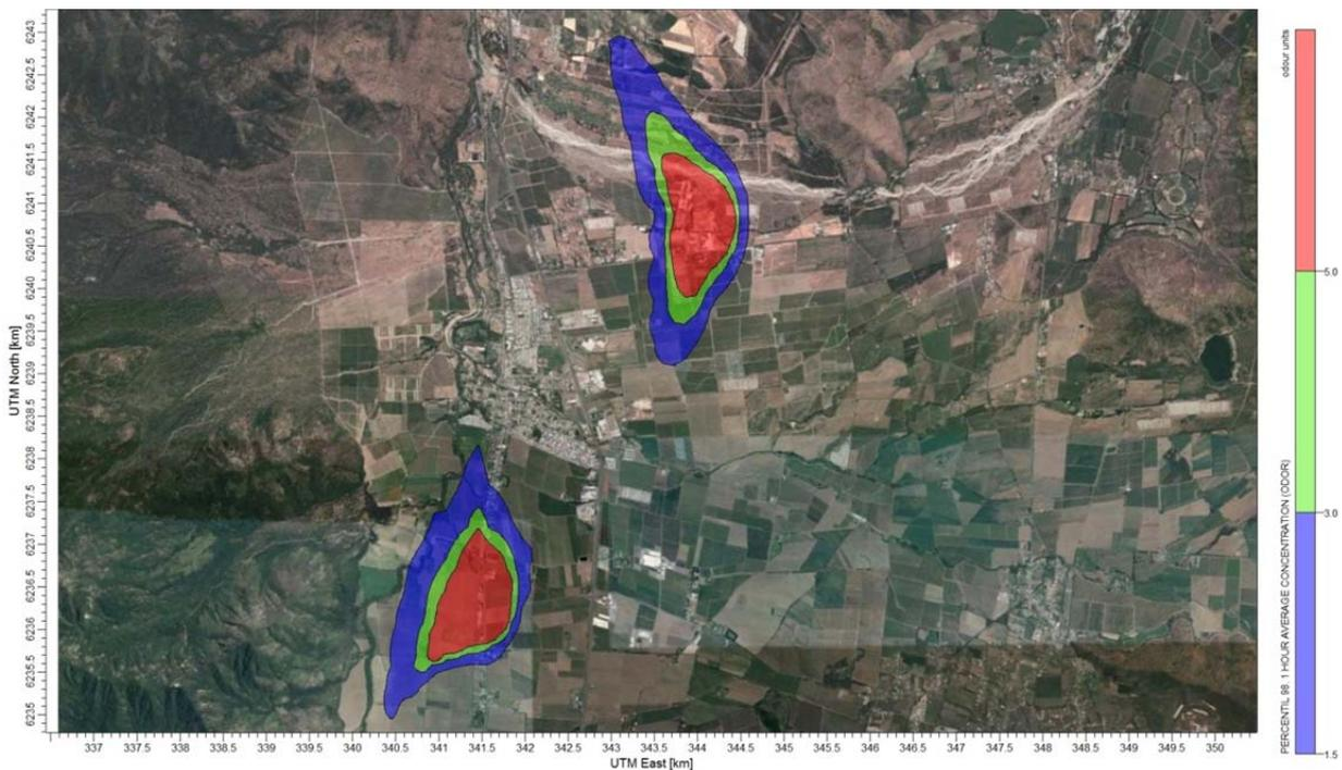
**Figura 6.** Modelización de las instalaciones de Cerdos DAG. Isodoras 1,5, 3 y 5 uoE/m<sup>3</sup> percentil 98. Representación sobre ortofotografía conjunto total de fuentes.
