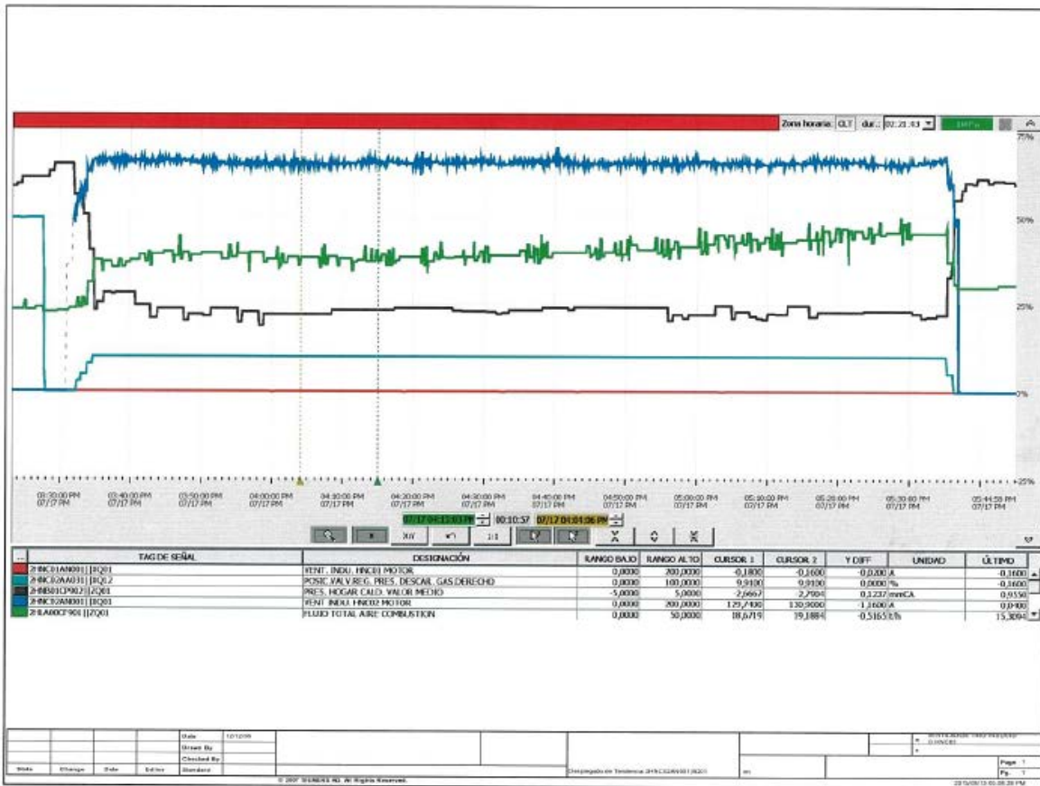
Figura N°1 Parámetros Operacionales en Caldera Unidad CTM2 Día 17 de julio 2014, entre las 03:30 y 06:45 PM
