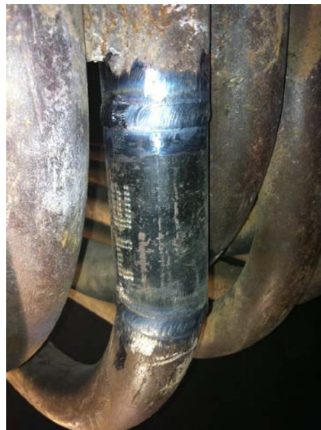
Foto 1: Grieta tubo en zona del Plenum y niple instalado
