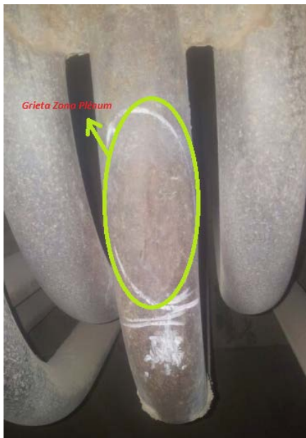
Foto 1: Grieta tubo en zona del Plenum y niple instalado
