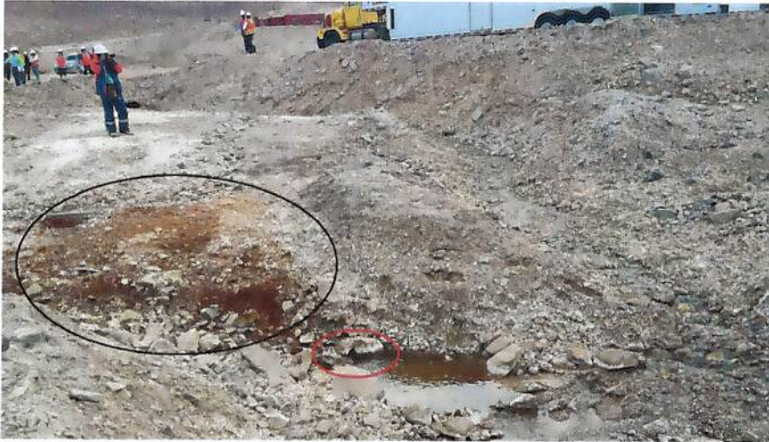
Imagen 12. Afloramiento de agua posiblemente contactada que emerge desde el subsuelo a unos 20 metros hacia el sur de la CCR. El círculo negro muestra la precipitación de óxidos de hierro, nótese que los sedimentos de alrededor no están con esa contaminación. El círculo rojo muestra de donde emerge el agua. Imagen tomada mirando hacia el este.
