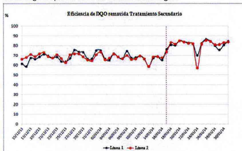
Figura 11. Eficiencia de remoción de DQO por el tratamiento secundario (Reactores biológicos).
