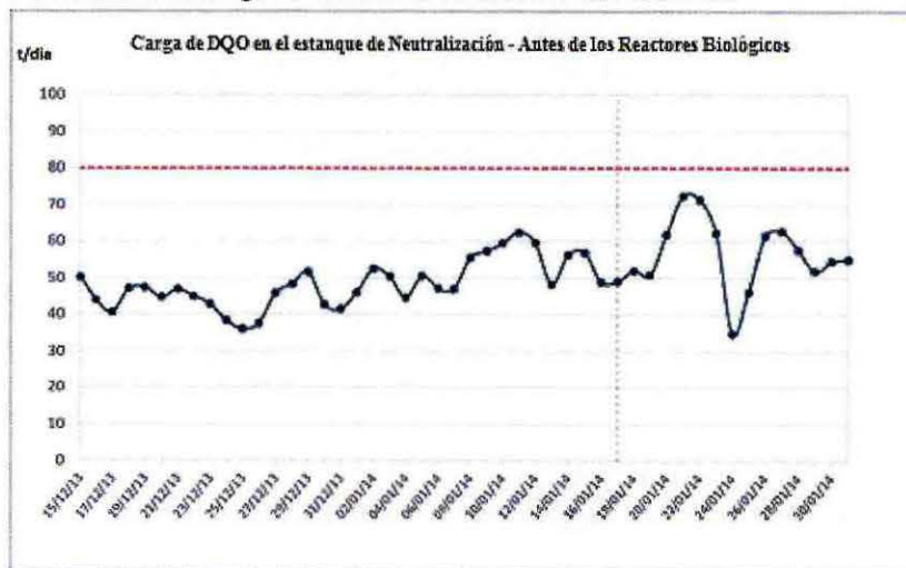
Figura 8. Cargas de DQO en la salida del tanque de neutralización - entrada del tratamiento biológico.
