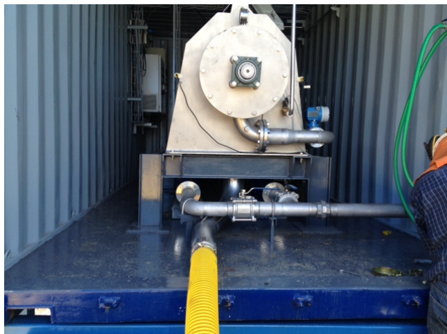
Foto N° 6: Conexión con mangueras a succión bombas.
