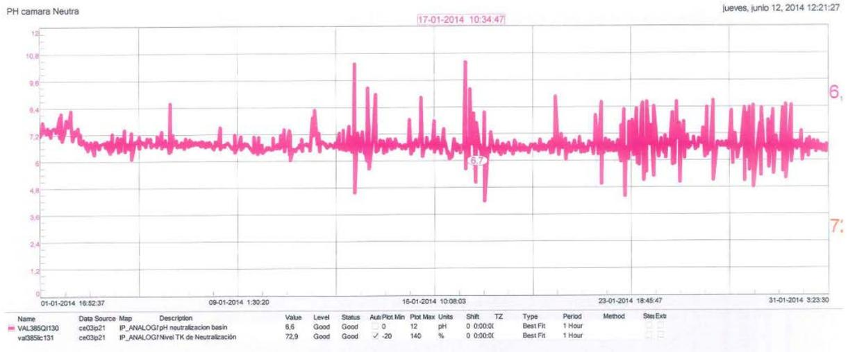
Figura N° 6.3 pH en Tk de aireación N° 1 y temperatura en torre de enfriamiento N° 1
